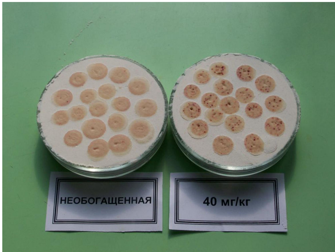
Качественный метод определения железа «Spot-test» (ААСС метод 40-40);
